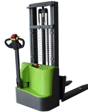
Grazie all'unità di controllo impermeabile, il carrello elevatore elettronico di alta qualità è perfettamente in grado di affrontare le condizioni di lavoro più difficili, come il freddo, l'umidità e la polvere, ed è ideale per l'uso temporaneo, ad esempio nelle celle frigorifere e nei capannoni di produzione. Il modello HE1500/4 non è progettato per l'uso permanente in celle frigorifere e in presenza di pioggia/umidità.
